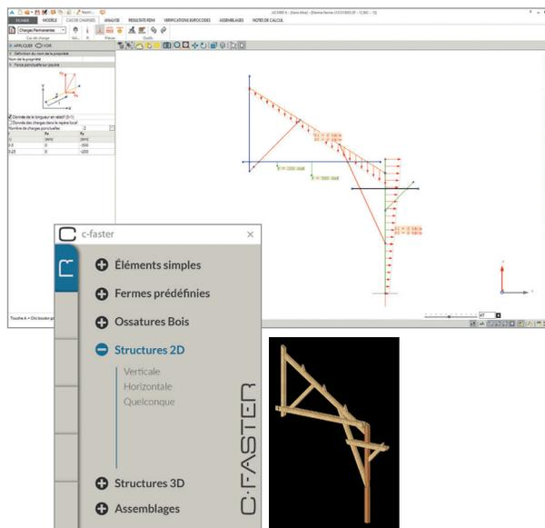
Acord-Bat 2D est dédié à l'analyse de structures planes sous charges quelconques.
